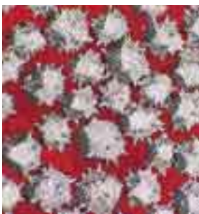
最新的超級針刺狀MBG SB金剛石，特別適合金屬軟胎體塗層比重: 占60%重量
