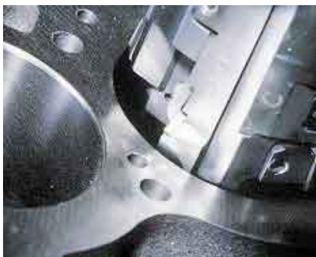
灰鑄鐵汽缸高速鏜孔 750-1200 m/min
